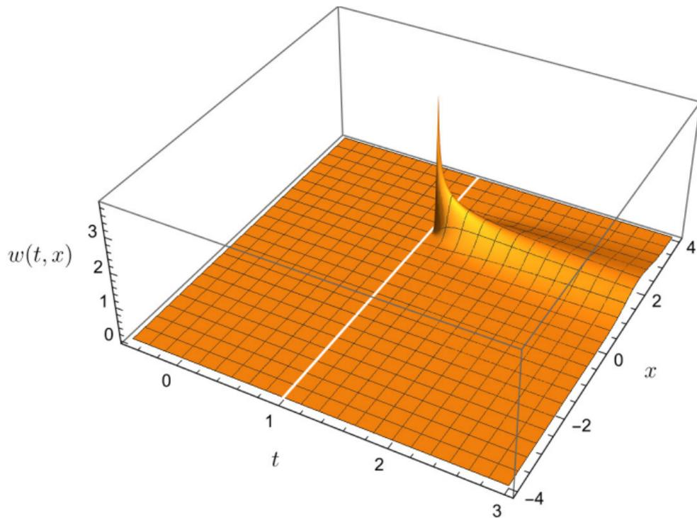
Equation de la chaleur ( $a = 0.1m^2/s$ ) : solution sous  $f$  et  $S$  ( $f_0 = 1, S_0 = 0.1$ ) avec ( $t_0 = 1s, x_0 = 2m$ )
